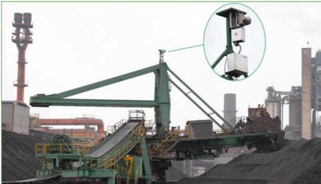
Die Produktapplikation **LaseBVH - Bulk Volume Heap** ist eine hochpräzise dreidimensionale Laser-Messanlage, die speziell für die Vermessung von Halden entwickelt worden ist.
