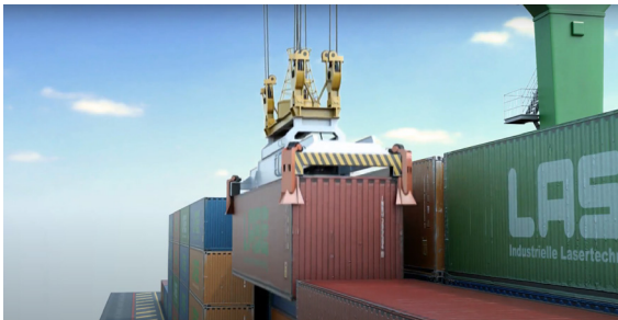
Das System sendet ein Warnsignal an den Kranführer, sobald sich eine Kollision anbahnt.
