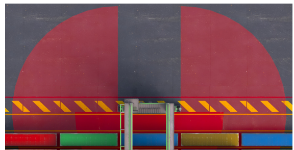
Sichtfeld des Scanners. Beobachtung von 270° der Umgebung.
