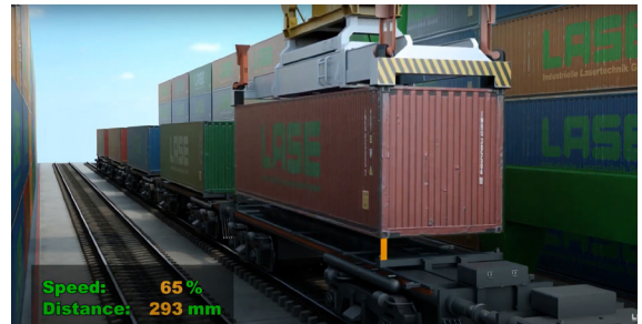
Die Anwendung ermittelt den Abstand zum Boden und reduziert automatisch die Geschwindigkeit.
