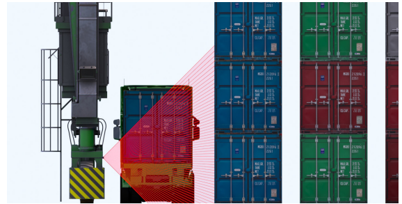
Die Sensoren beobachten den Bereich in der Fahrspur.
