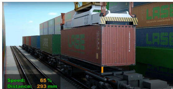
Die Anwendung ermittelt den Abstand zum Boden und reduziert automatisch die Geschwindigkeit.
