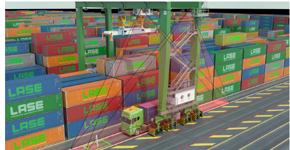
Montagepositionen der Laserscanner.
