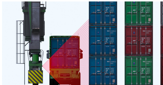
Die Sensoren beobachten den Bereich in der Fahrspur.
