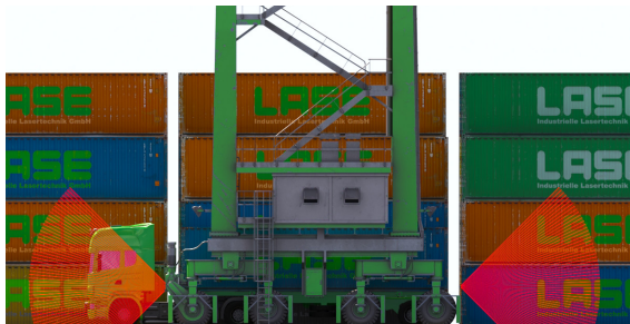
Die Sensoren beobachten den Bereich vor dem Kran.
