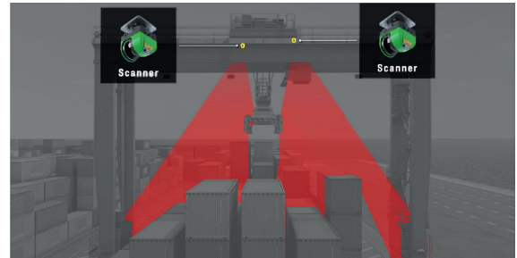
Die Sensoren messen kontinuierlich die Abstände zu den umliegenden Containern, um Kollisionen zu vermeiden.
