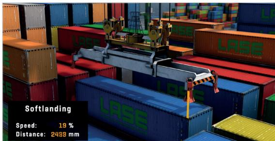
Beim Absetzen des Containers wird die Geschwindigkeit mit abnehmender Entfernung reduziert.
