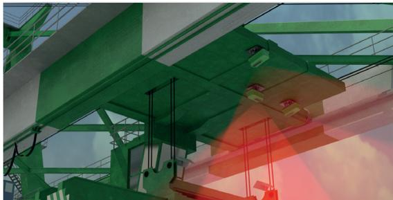
Retrofit-Lösung: Die Scanner und Referenzplatten werden am STS-Kran befestigt.
