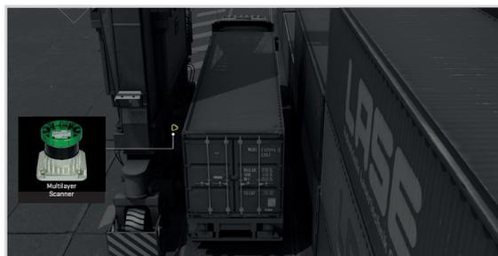
Der Multilayer-Scanner am Kran erkennt den Abstand zwischen dem Fahrgestell und der Last auf dem Lkw.
