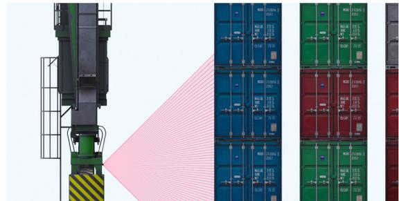
Montageposition des Laserscanners.
