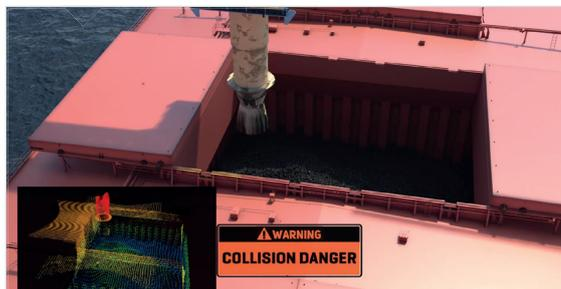
Im Falle einer drohenden Kollision wird ein Warnsignal ausgelöst
