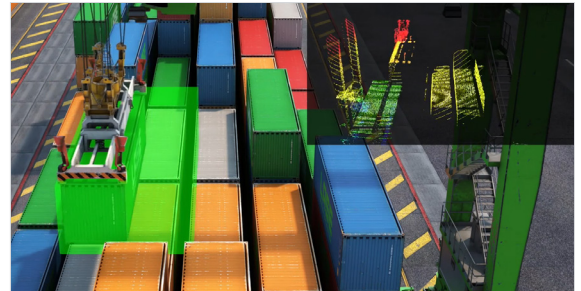
Das System erstellt ein 3D-Profil des Containerstapels im Betriebsbereich und den angrenzenden Bereichen.
