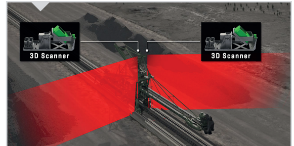
Retrofit-Lösung: bis zu zwei 3D-Laserscanner werden an einem Stapler/Reclaimer installiert.
