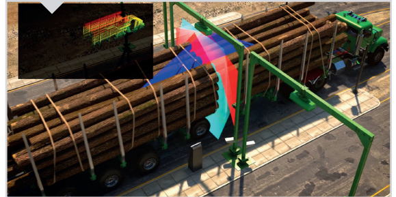
Die Scanebenen „umschließen“ das Holz während der Fahrt und berechnen automatisch das Volumen.
