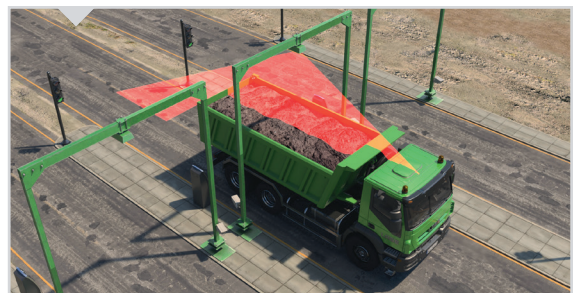
Der (Bergbau-)LKW hält unter dem Rahmen/Ausleger; der Messvorgang wird gestartet.
