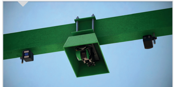
Die wetterfesten Laserscanner werden an einem Gestell oder Ausleger in zentraler Position über dem Messbereich montiert.
