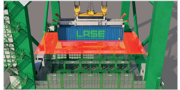
Die Scanner bilden eine rechteckige Scanebene, die alle Ecken des Containers abdeckt.
