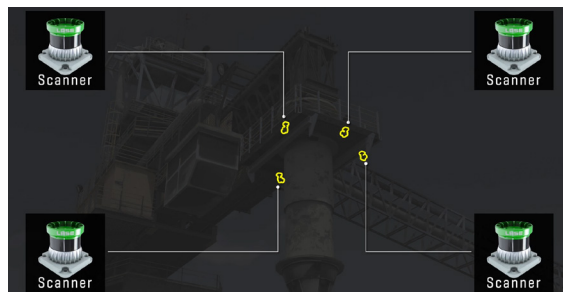
Die Scanner werden um die Rutsche oder den vertikalen Balken der Maschine herum montiert.
