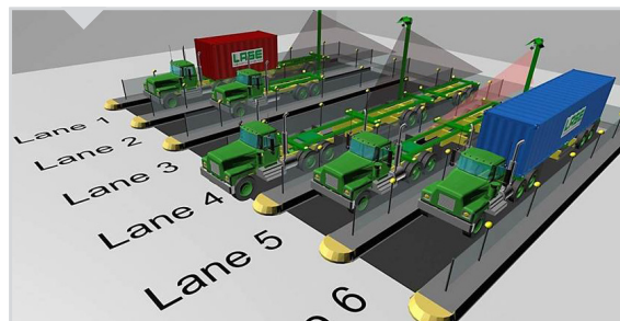
LaseTDS scannt die leeren und vollen Lastwagen. Zwei Sensoren sind an einem Mast montiert.
