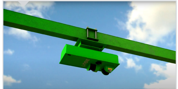
Zwei 2D-Laserscanner werden auf einem Rahmen über dem Gleis positioniert.
